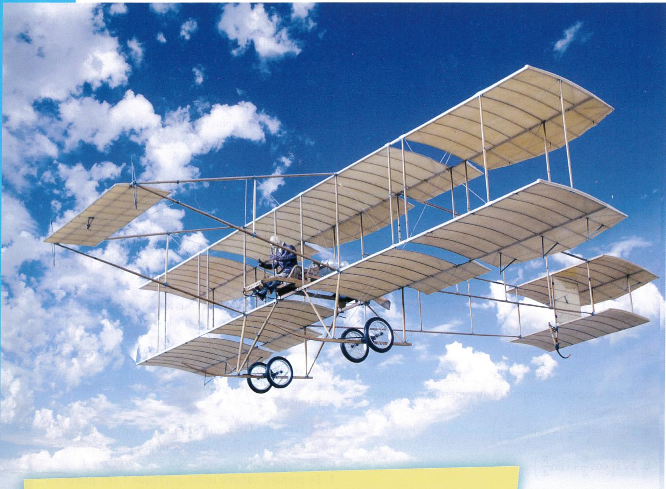
La Physique d'un avion en vol peut se résumer par l'équilibre de quatre forces opposables deux à deux : la portance et le poids, la traction et la traînée. L'énergie fournie par chacune de ces quatre forces se calcule avec un outil mathématique qui est le produit scalaire.
