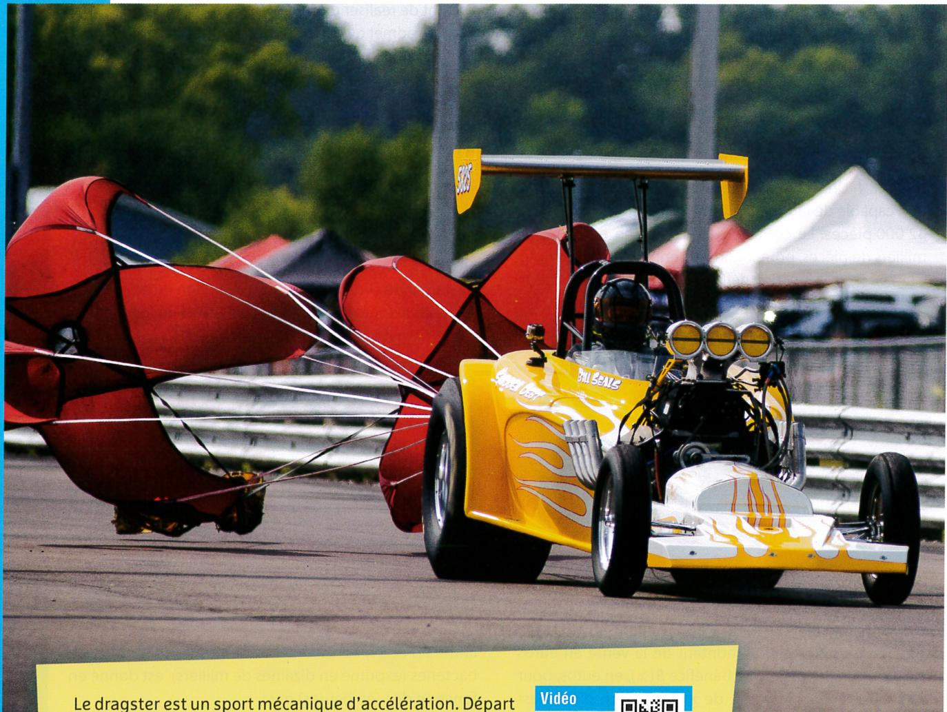
Le dragster est un sport mécanique d'accélération. Départ arrêté, il s'agit de mettre le moins de temps possible pour franchir une distance de 402 mètres (depuis 2012, de 305 mètres). Ces engins sont propulsés par des moteurs pouvant dépasser les 8 000 chevaux<sup>2</sup> et le temps de course dure moins de 5 secondes, c'est très court !
